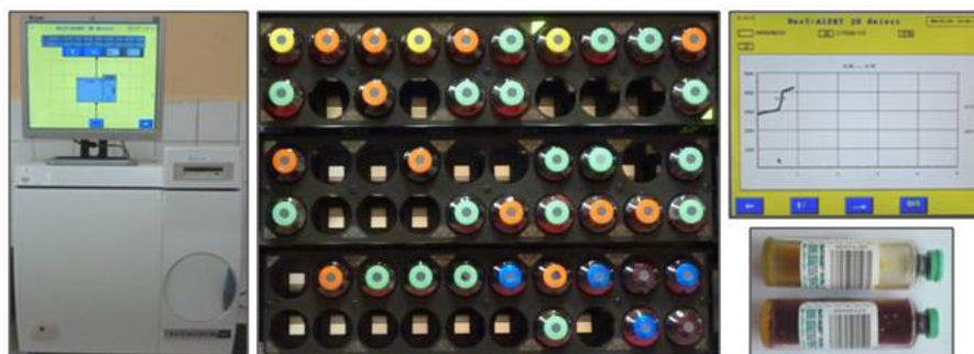
Rycina 2 BacT/ALERT 3D - automatyczny system detekcji mikroorganizmów: widok aparatu; komory inkubacyjne, oznakowane kolorami butelki z podłożami transportowo-wzrostowymi dla różnych warunków hodowli (tlenowych, beztlenowych, po antybiotykoterapii), widoczne 2 podświetlone dodatnie próbki; wykres wskazujący czas detekcji; metoda kolorymetryczna oparta na zmianie barwy dna butelki w wyniku wytwarzania CO2 i kwasów organicznych. BacT/ALERT 3D - automated microbial detection system: view of the instrument; incubation chambers, color-coded bottles with transport media for different culture conditions (aerobic, anaerobic, previous antibiotic therapy), two samples lighted as positive; graph showing detection time; colorimetric method based on tint changed of bottle bottom due to production of CO2 and organic acids.
