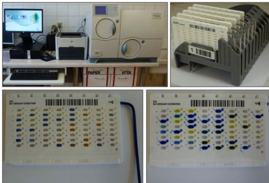
Rycina 5 VITEK 2 Compact - automatyczny system identyfikacji i oceny lekowrażliwości: widok aparatu; próbówki zawierające zawiesiny drobnoustrojów; karta identyfikacyjna przed użyciem oraz po przeprowadzeniu testów. VITEK 2 Compact - automated identification/antimicrobial susceptibility testing system: view of the instrument; test-tubes containing pathogen solutions; identification card before and after testing.
